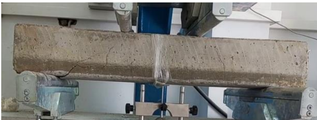
Figure (VI-5) : Mode de rupture par cisaillement des poutres renforcées par M1
