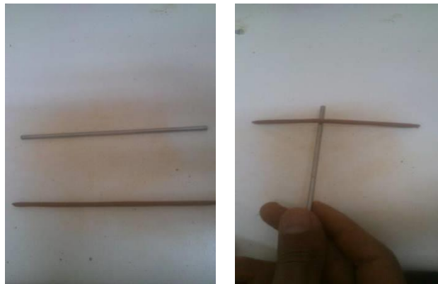
Figure II-10 : préparation des limites de plasticité
