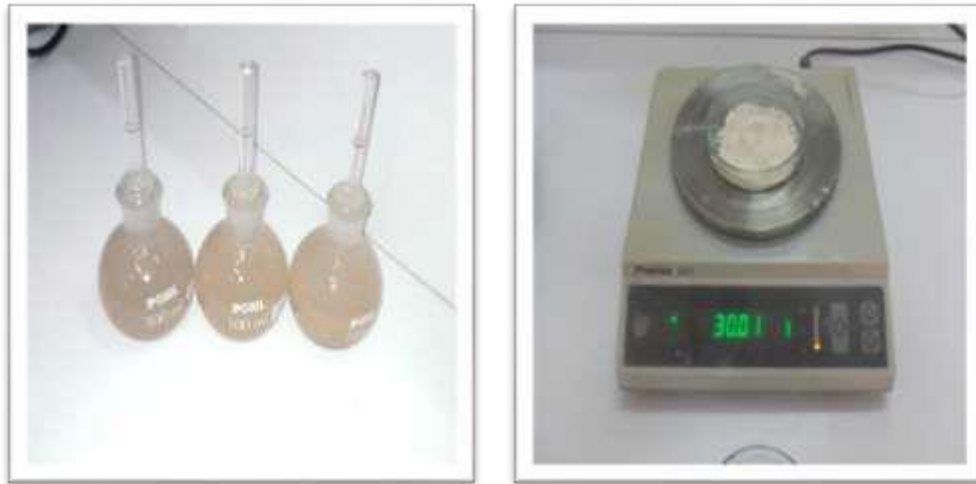
Figure II-6 : manipulation pycnomètre.
