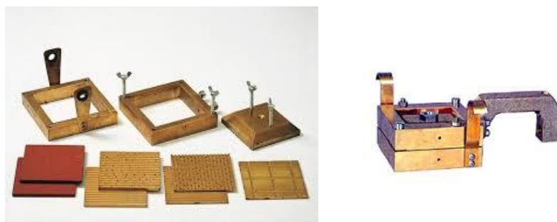
Figure II-16 : la boîte de cisaillement
