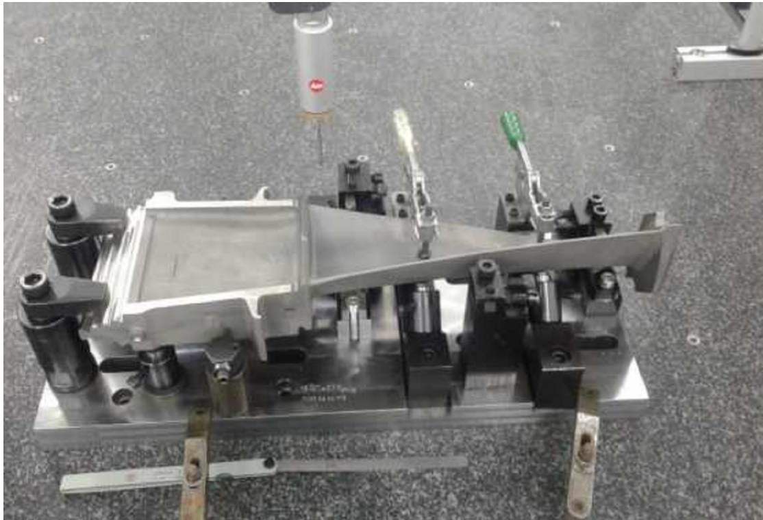
Figure 38 : Mesure de la qualité de posage de l'ailette sur son montage sur la machine à mesurer tridimensionnelle (MMT)
