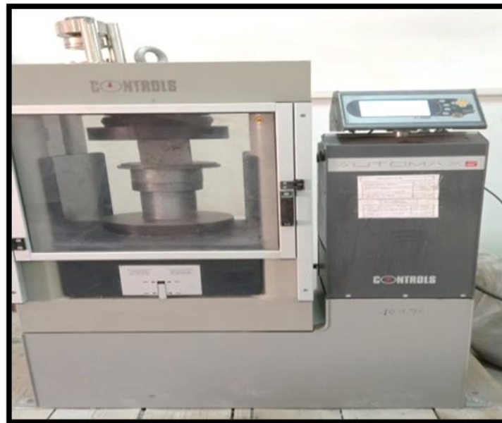
Figure III.12. Machine d'essai de résistance à la compression
