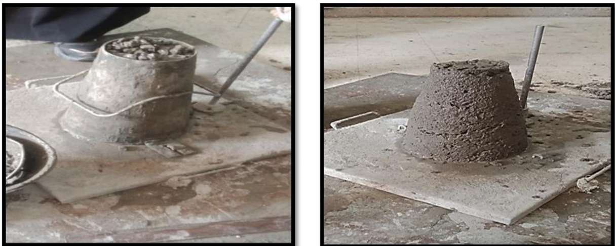
Figure III.10. Essai d'affaissement au cône d'Abrams
