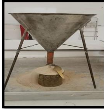
Figure III.2. Détermination de la masse volumique apparente.
