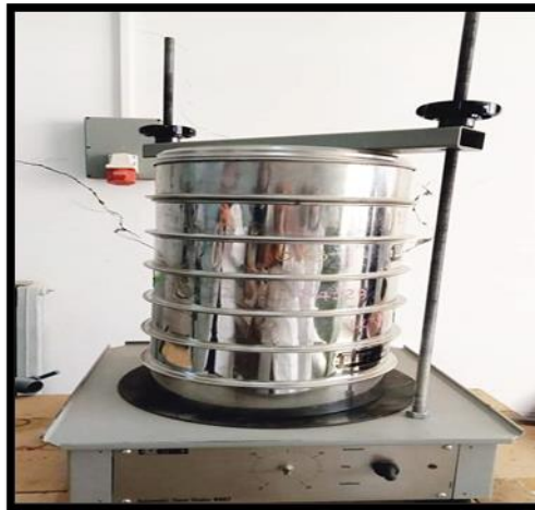
Figure III.4. Analyse granulométrique par tamisage
