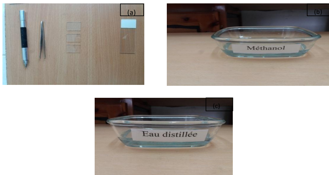
Figure II.1: (a) : Stylo diamanté, substrat de verre et pincette, (b) : bain de méthanol, (c) : bain de l'eau distillée.
