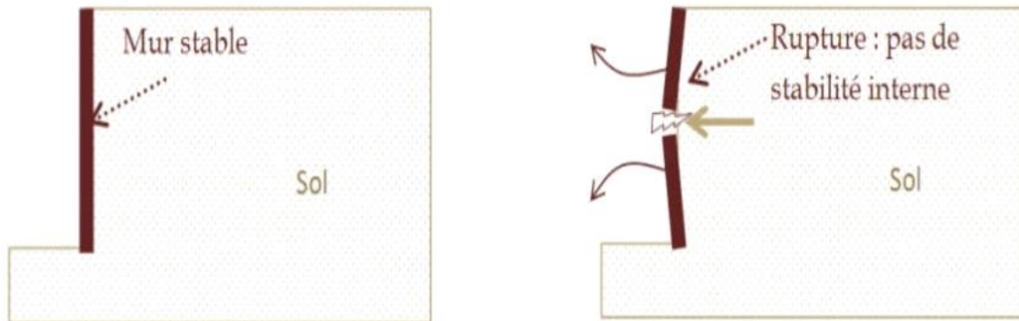
Figure I.6: Modes de rupture des ouvrages de soutènement.
