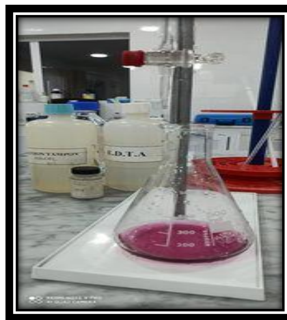
Figure N°27 : Virage de l'indicateur Coloré lors du dosage de la dureté
