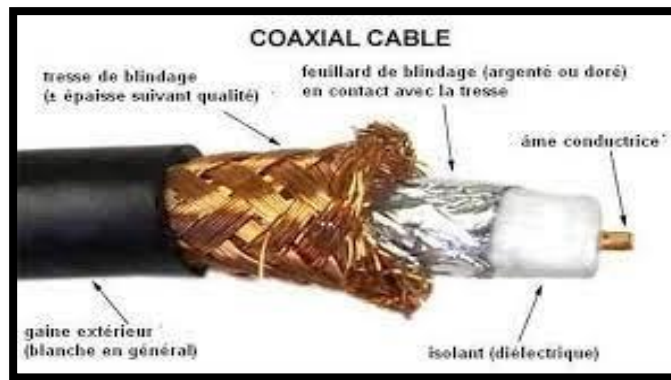
Figure 1.3: Description matérielle d'un câble coaxial.
