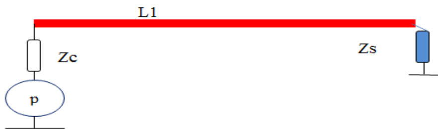
Figure 2.7 : Représentation schématique d’une ligne bifilaire simple
