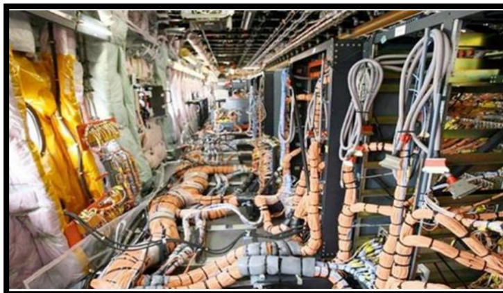
Figure 1.9: Réseau filaire d'un avion [5].
