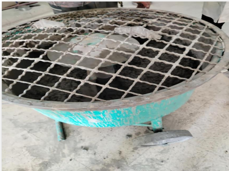
Figure 4-11: Le malaxeur utilisé (malaxeur de laboratoire Géo-matériaux).
