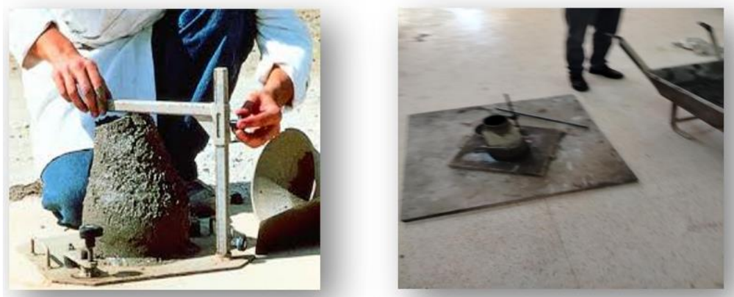
Figure 4-12 : L'affaissement de cône d'Abrams d'un béton.
