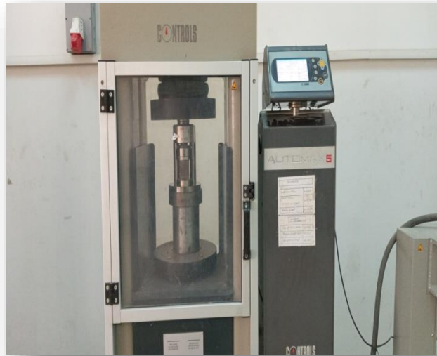
Figure 4-15: Machine d'essai de compression
