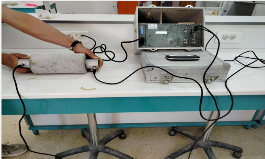
Figure 4-17: l'appareille d'essai ultrasonique
