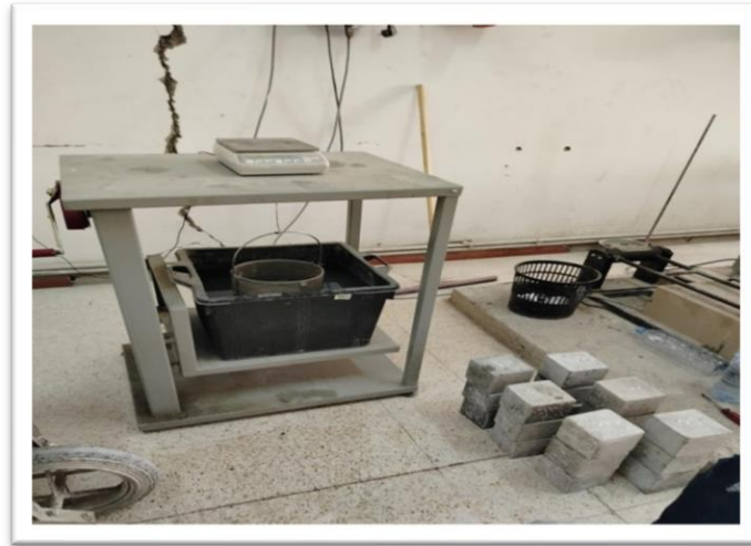
Figure 4-16: Pesée hydrostatique et l'appareille pour chauffer(ébullition)du béton
