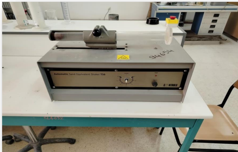
Figure 4-5: Essais d'équivalent dessable.
