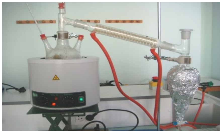
Fig.6 : Schéma de principe d'une extraction par hydrodistillation
