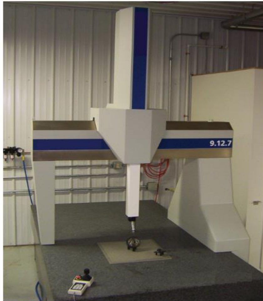
Figure 1.12 : Machine à mesurer tridimensionnelle à portique [13].
