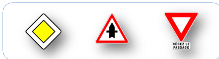
Figure N°13 : exemples de panneaux d'intersection et de priorité
