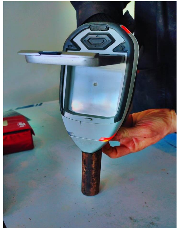
Figure V-2 : Analyseur XL3t GOLDD+ XRF de thermique Scientifique Niton
