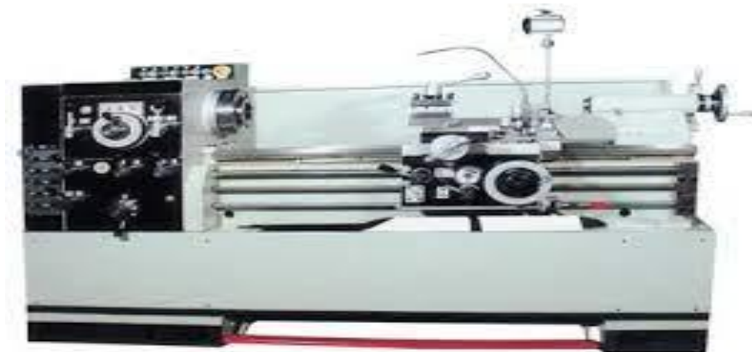
Figure I-8 : Les tours semi-automatiques
