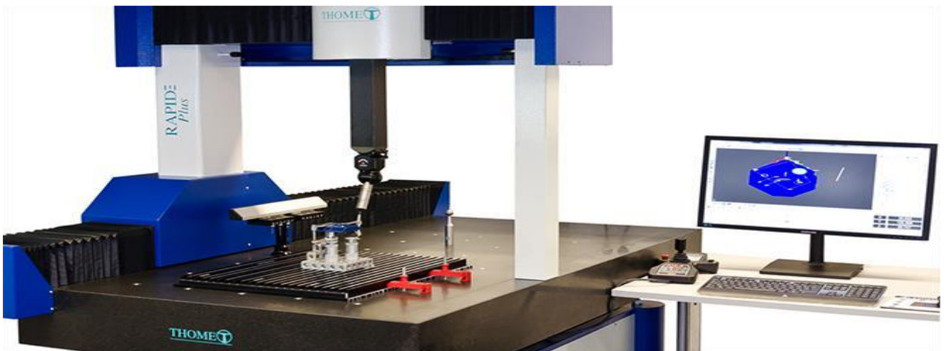
Figure IV-8 : Appareil de mesure tridimensionnelle
