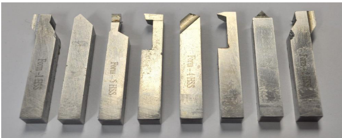
Figure II-12 : Outil de tournage en HSS
