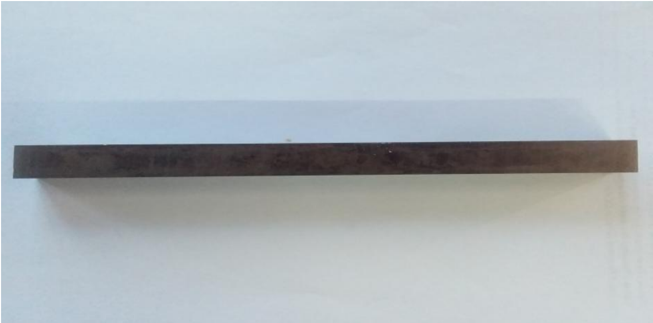
Figure V-6 : barreau en acier rapide supérieur (ARS)
