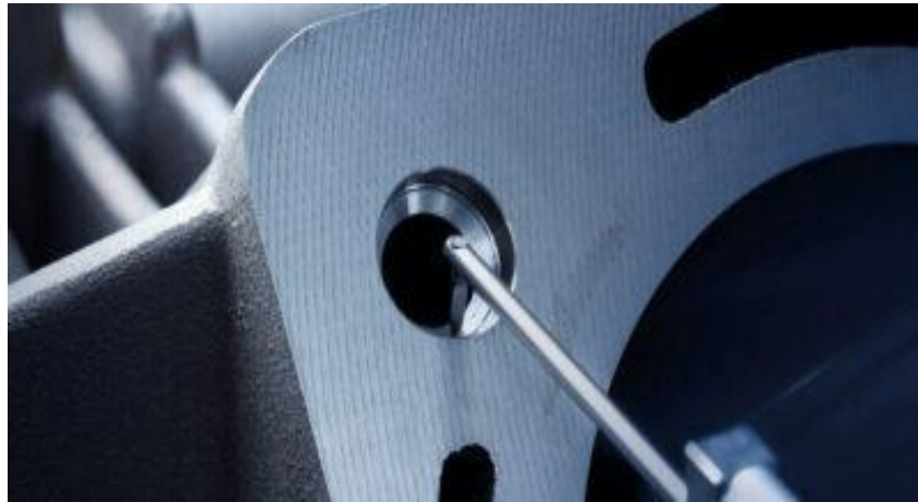
Figure IV-7 : Rugosimètre avec patin
