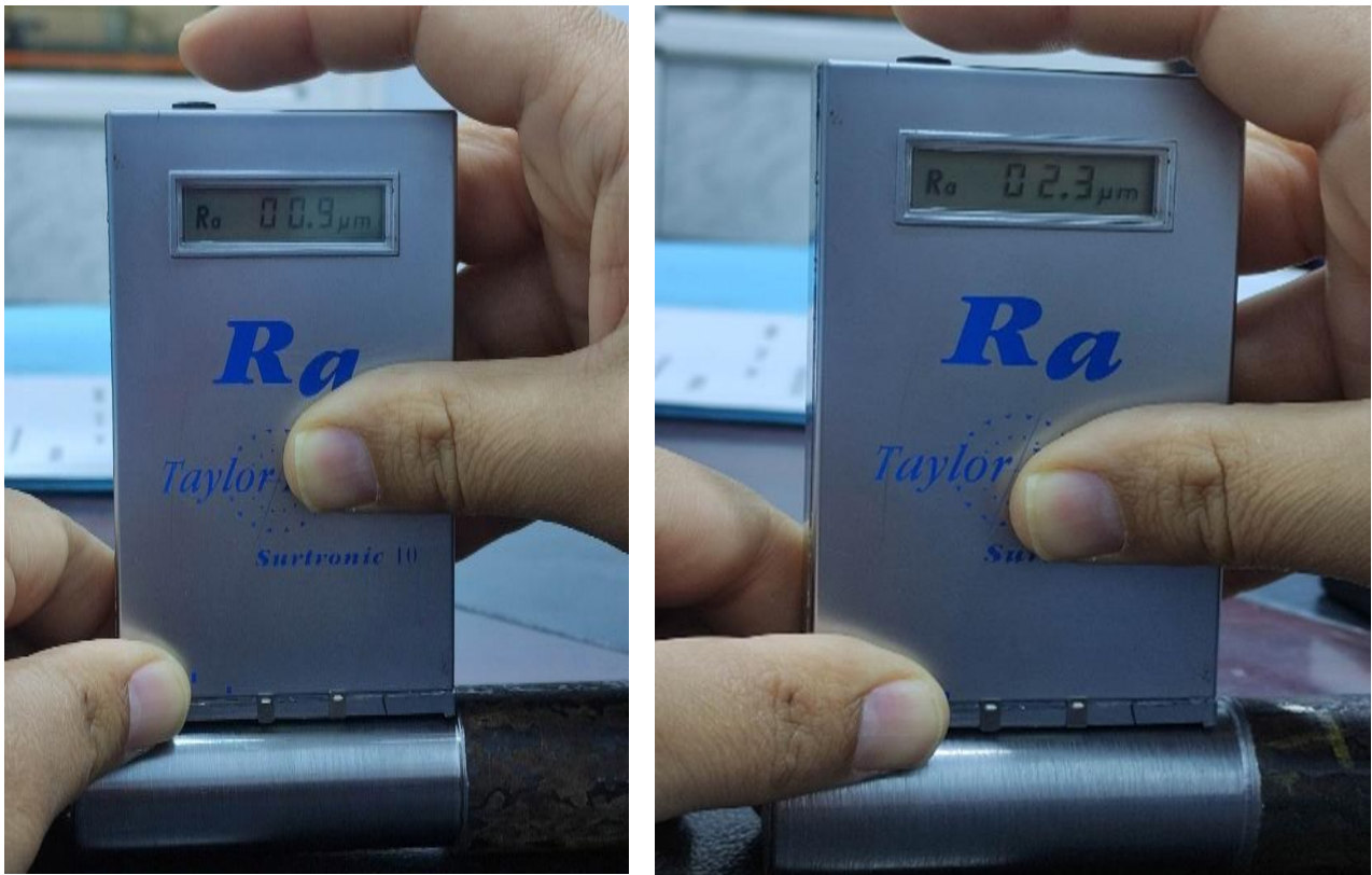
Figure V-4 Appareil de mesures surface Taylor-Hobson Surtronic 10
