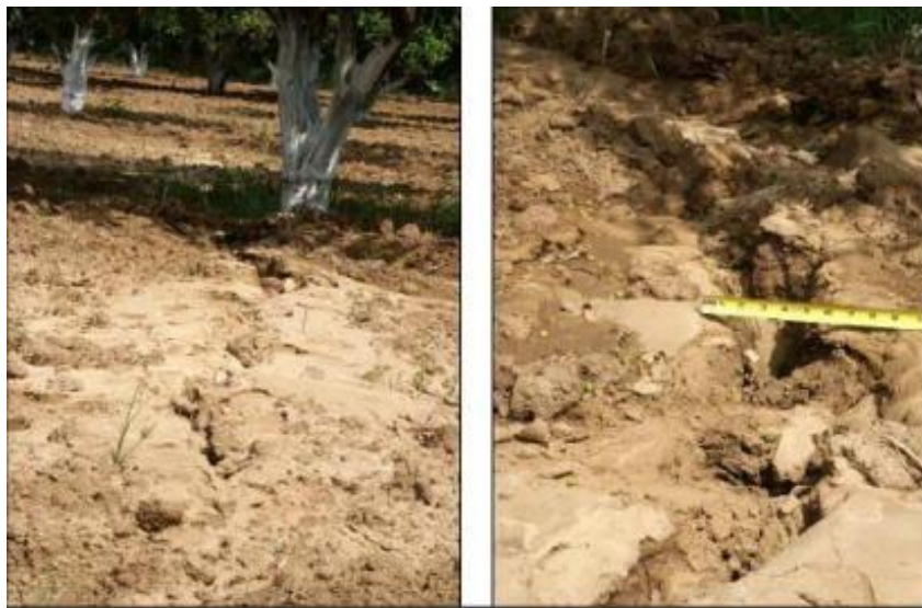
Figure 1.30 : Liquéfaction près de la ville de Zemmouri (ébullitions de sable). (D'après le EERI, 2003, cité par Hadaden nassima 2008)
