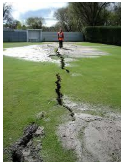
Figure 1.33 : Ebullitions de sable dues à la liquéfaction, après le tremblement de terre à Christchurch, New Zealand (2011)
