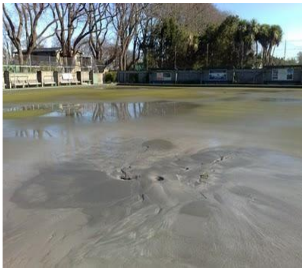
Figure 1.33 : Ebullitions de sable dues à la liquéfaction, après le tremblement de terre à Christchurch, New Zealand (2011)
