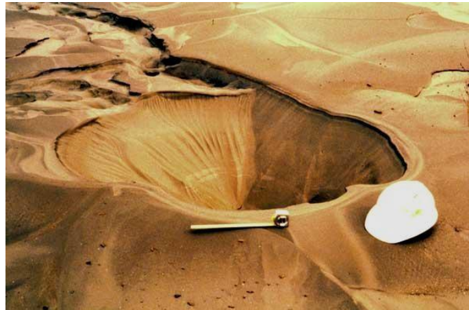
Figure 1.15 : Ebullition de sable à l'aéroport d'Oakland, le long du fleuve de Salina et à la station marine de Moss Landing (D'après Robert E. Kayen et al, 1998).
