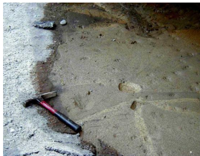
Figure 1.25 Ebullition de sable en Turquie 1999 (d'après Peter M. Byrne et al, 2008).
