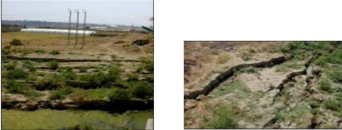
Figure 1.29 : Liquéfaction due à l'épandage latéral (D'après le EERI, 2003, cité par HADDADENE Nacima 2008)
