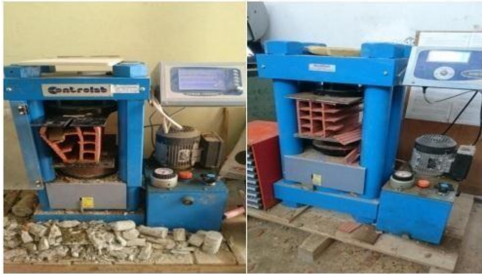
Figure 49: la machine d'essai et les éprouvettes après les essais
