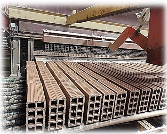
Figure 39: Entrée de séchoir
