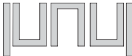
Fig. II.15 Structure d'un filtre en épingle à cheveux.
