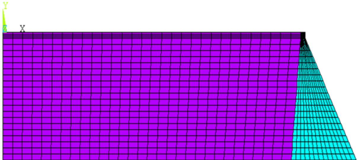
Figure IV.3 : Discrétisation par éléments finis du système barrage-réservoir
