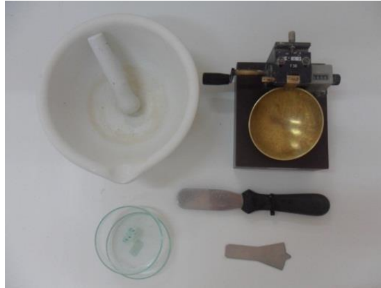
Figure VI.2 : Matériels spéciaux de limites d'Atterberg.
