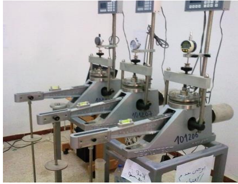
FigureVI.20 - Les machines utilisées pour l'essai œdométrique laboratoire
