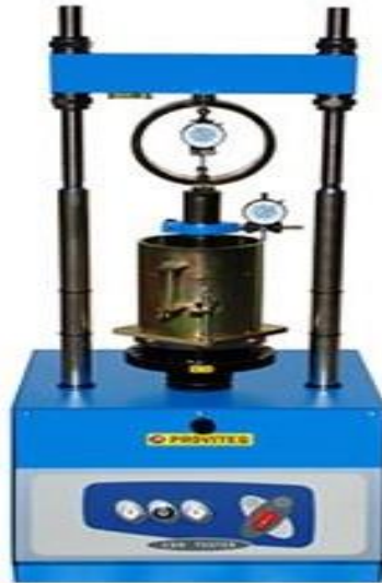
Figure VI.14 - Appareil de poinçonnement (essai CBR).
