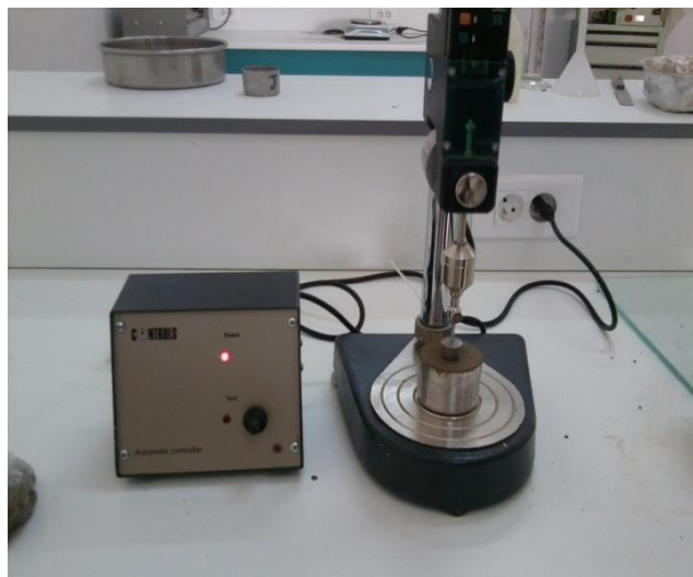
Figure VI-3 : L'appareil de la pénétration du Cône
