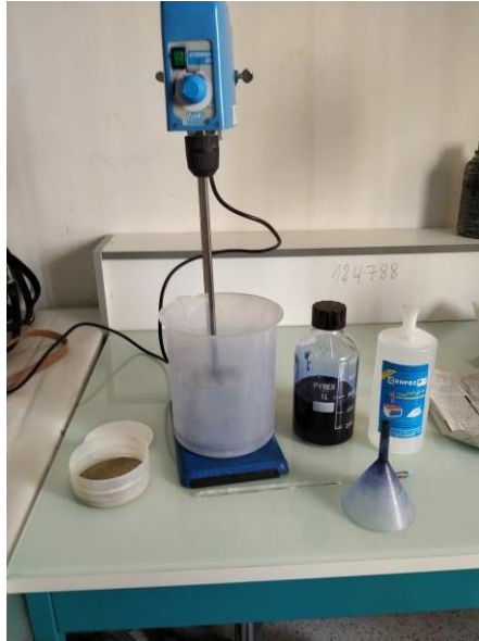
FigureVI.11 - Appareillage de l'essai au bleu de méthylène
