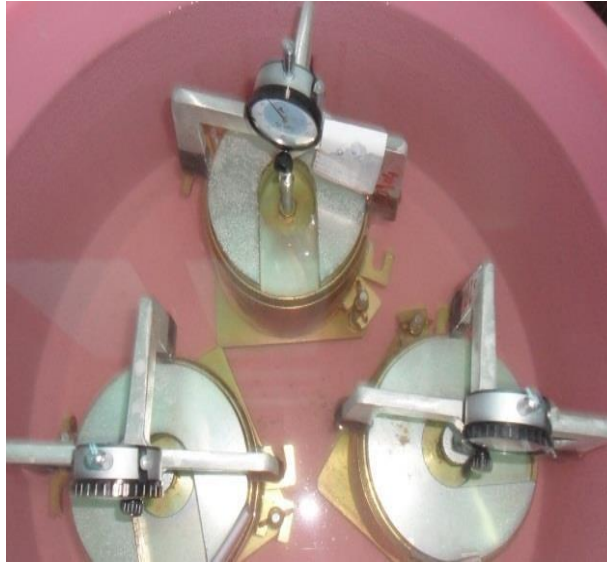
Figure VI.15 - Imbibition des échantillons (essai CBR).
