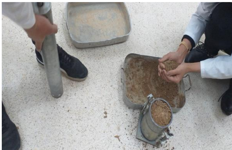
Figure VI.13 - Compactage de l'échantillon
