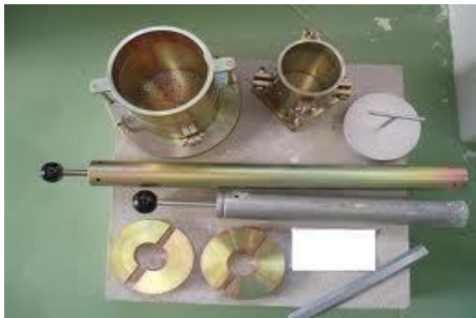
Figure VI.12 - Matériel de Proctor (normal et modifié).
