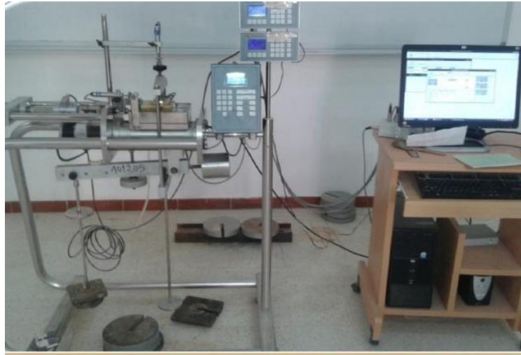
Figure VI.16 -Appareille de cisaillement rectiligne.
