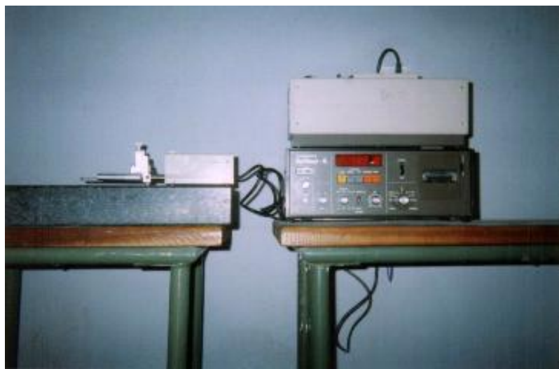
Fig.IV.7 : Rugosimètre à stylet de type "MITUTOYO Surfrest - 4".
