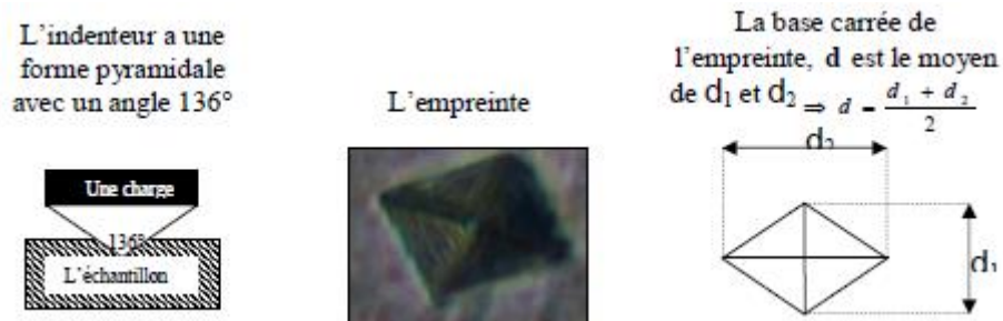
Figure .III.32. Pénétrateur et l'empreinte d'indentation.
