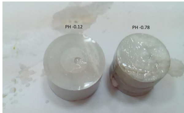
Figure .III.35. Effet de l'acidité sur l'aspect de l'échantillon.
