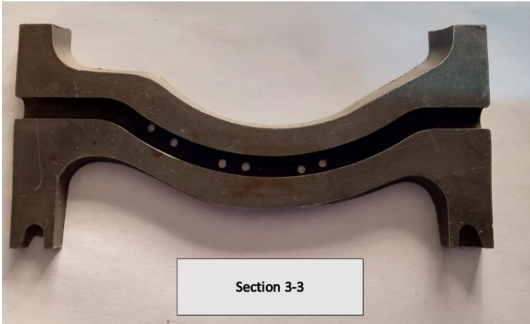
Figure V 42: Disposition des trous de refroidissement à l'intérieur de l'intersection cavité/pale
