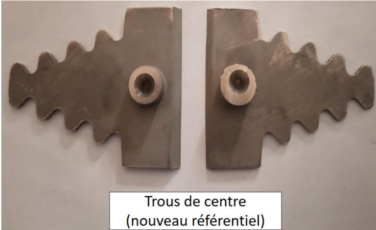
Figure V 43: Trous de centre (nouveau référentiel) après découpage par EDM.
