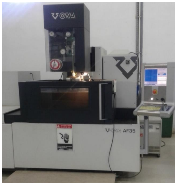
Figure IV 15: Machine EDM à fil type ONA AF35
