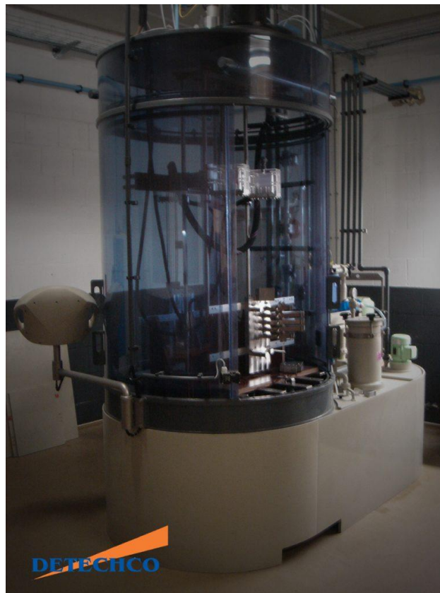
Figure V 36: Machine ECD pour le perçage électrochimique
