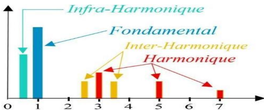
Figure (I. 2)- Représentation spectrale d'un signal pollué
