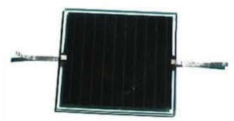
Figure I.17 ;Cellule sans silicium en couche mince
