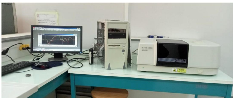
Fig.III.19. Spectromètre IR à TF (ATR)(8300)
