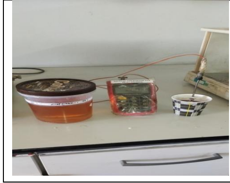
الشكل (16) جهاز قياس مدة تصلب الرانتج
