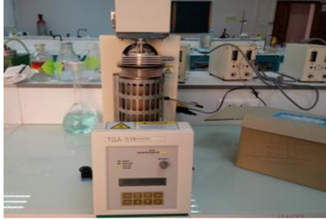
شكل (22): جهاز التحليل الوزني الحراري (ATG)
