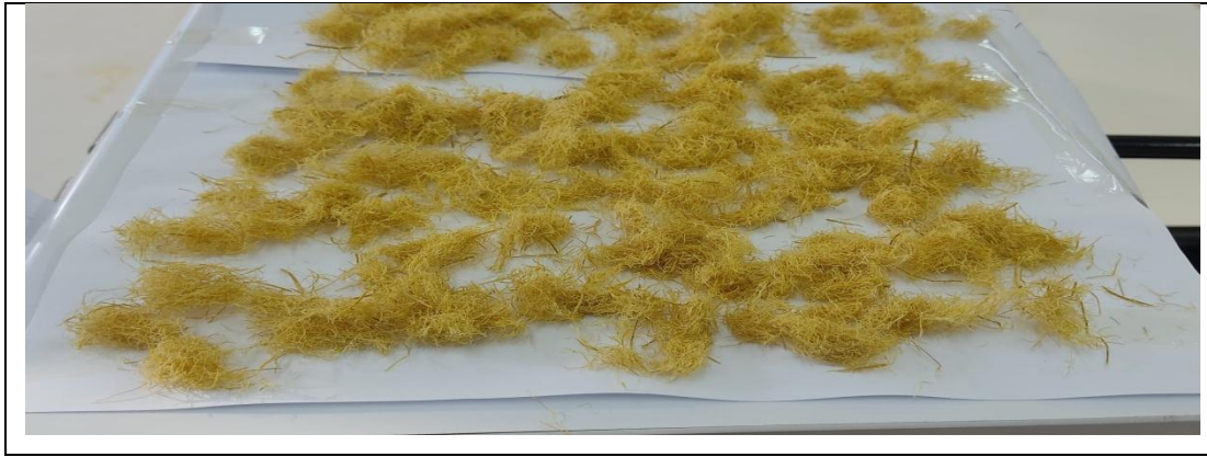
الشكل (12). الألياف بعد عملية المعالجة الميكانيكية.
