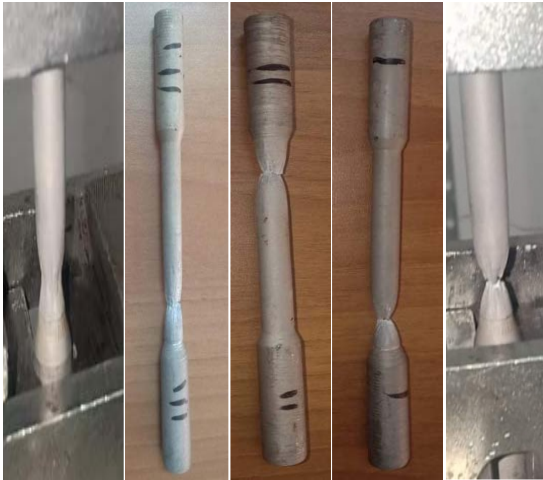
Figure (III.9) : Forme d'éprouvette cylindrique après rupture
