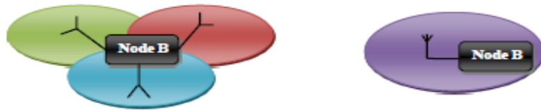
NodeB avec Antenne sectorielle
