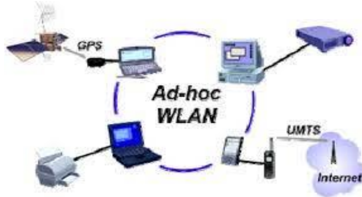
Figure (I.4): Réseaux en mode ad hoc.
