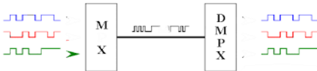
Figure (I.6) : Multiplexage des possibilités d'accès à un canal.
