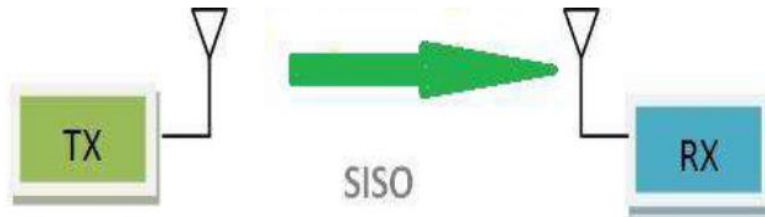
Figure (II.9): modèle du canal SISO.
