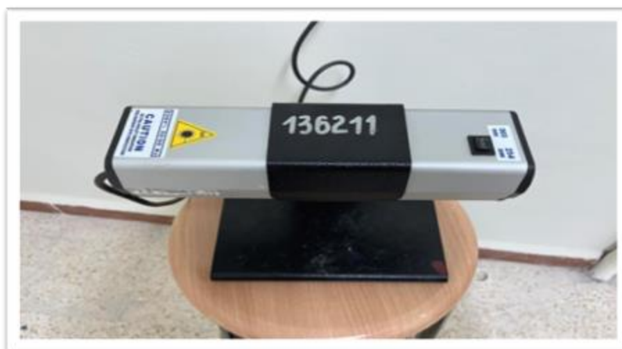
Figure 20 : Appareil de l'Ultra-violet pour l'observation des couleurs de la séparation.
