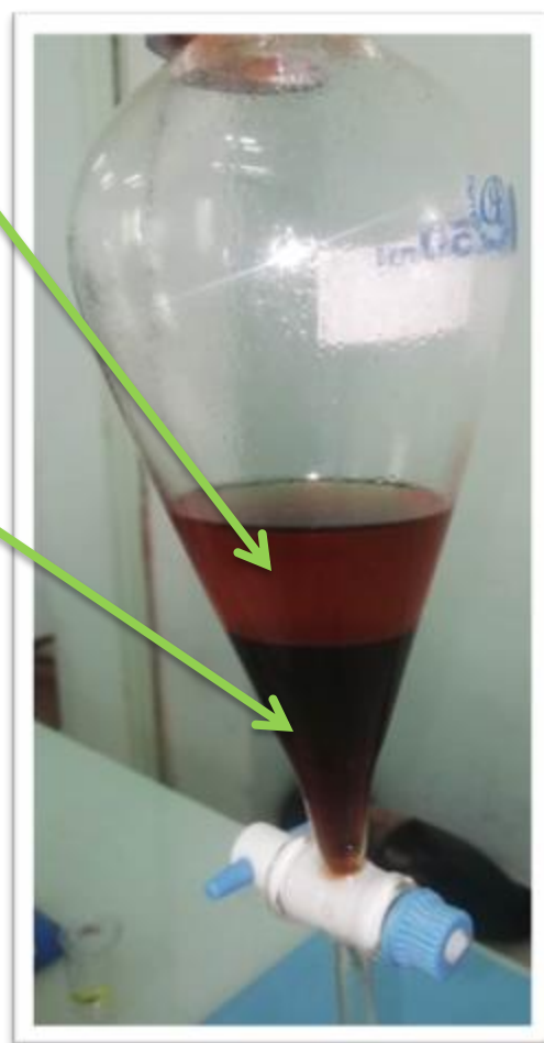
Figure 16 : Extraction liquide-liquide par n-butanol
