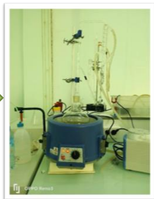
Figure 19 : photo originale de l'appareil d'hydrodistillation (clevenger)
