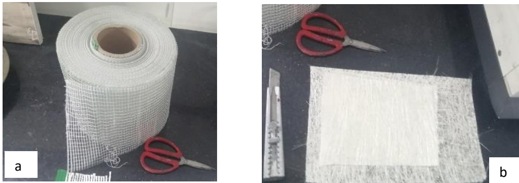
Figure. III.3 : Les renforts utilisés : a) fibres de verre de type-A , b) fibres de verre de type-E pour mat.
