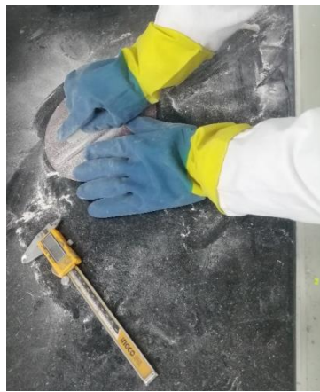
Figure III. 8. Polissage après découpage des éprouvettes.
