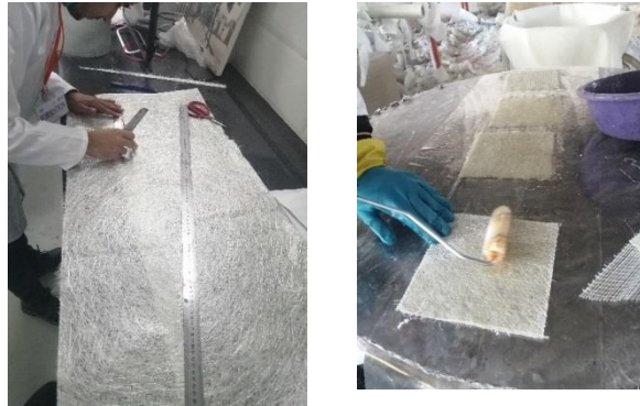
Figure III. 4. Préparation des plaques à base de fibres type-A.
