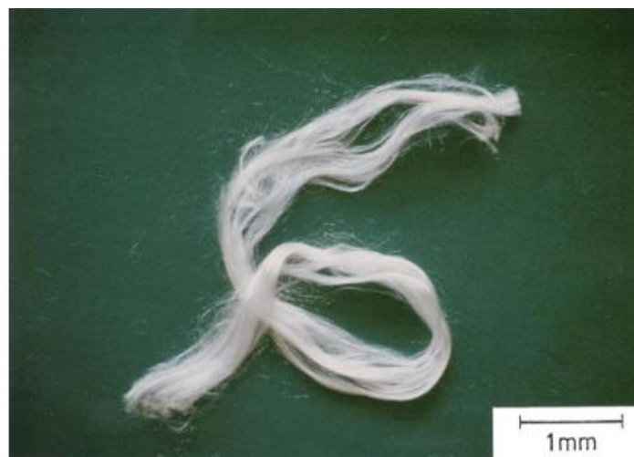
Figure I-9 : Fibres de verre continues (découpées en bobine) obtenues par la technique sol-gel [de Sakka (1985), utilisé avec permission]. [11]
