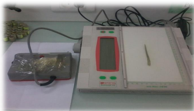
Figure 20 : Mesure de la surface foliaire des feuilles des variétés d'orge par planimètre.
