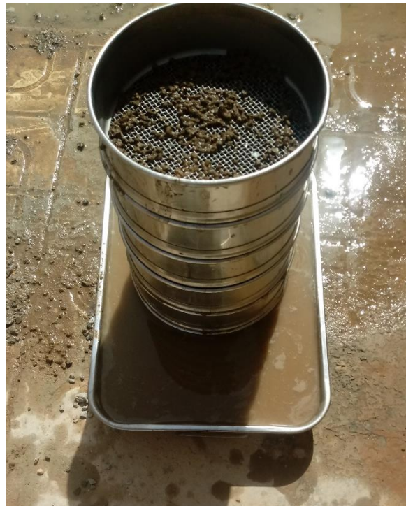
Figure III.4: L'analyse granulométrique par des tamis manuellement humide
