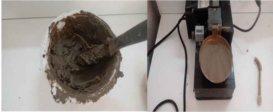
Figure III.7: Détermination de la limite de liquidité
