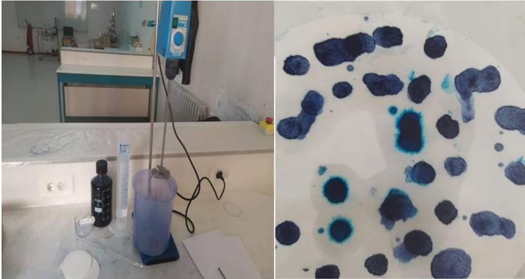
Figure III.9: Matériels pour essai au (VBS). bleu de méthylène
