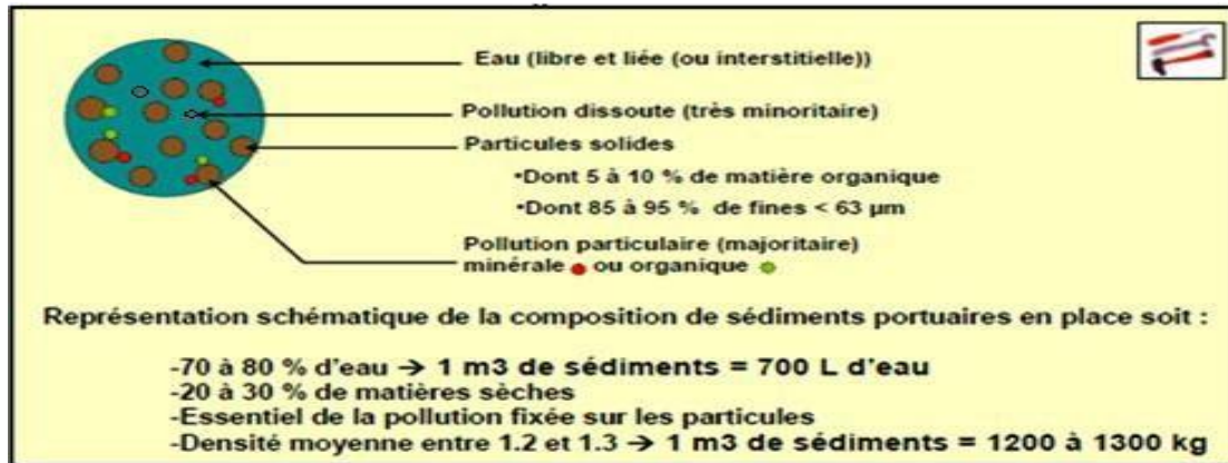
Figure I.13: Schéma de la composition simplifiée des sédiments portuaires
