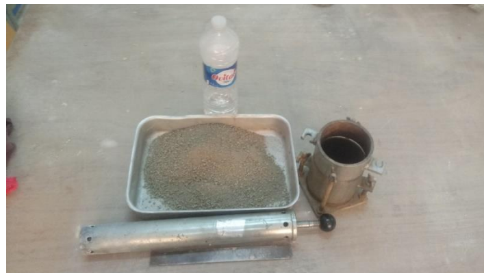
Figure III.10: Matériel de l'essai Proctor normal
