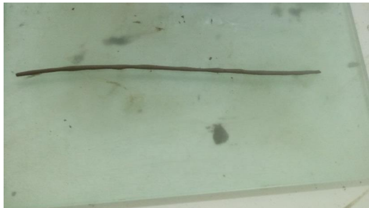
Figure III.8: Formation des rouleaux pour la détermination de W_p
