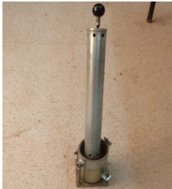
Figure III.11: Compactage de l'échantillon
