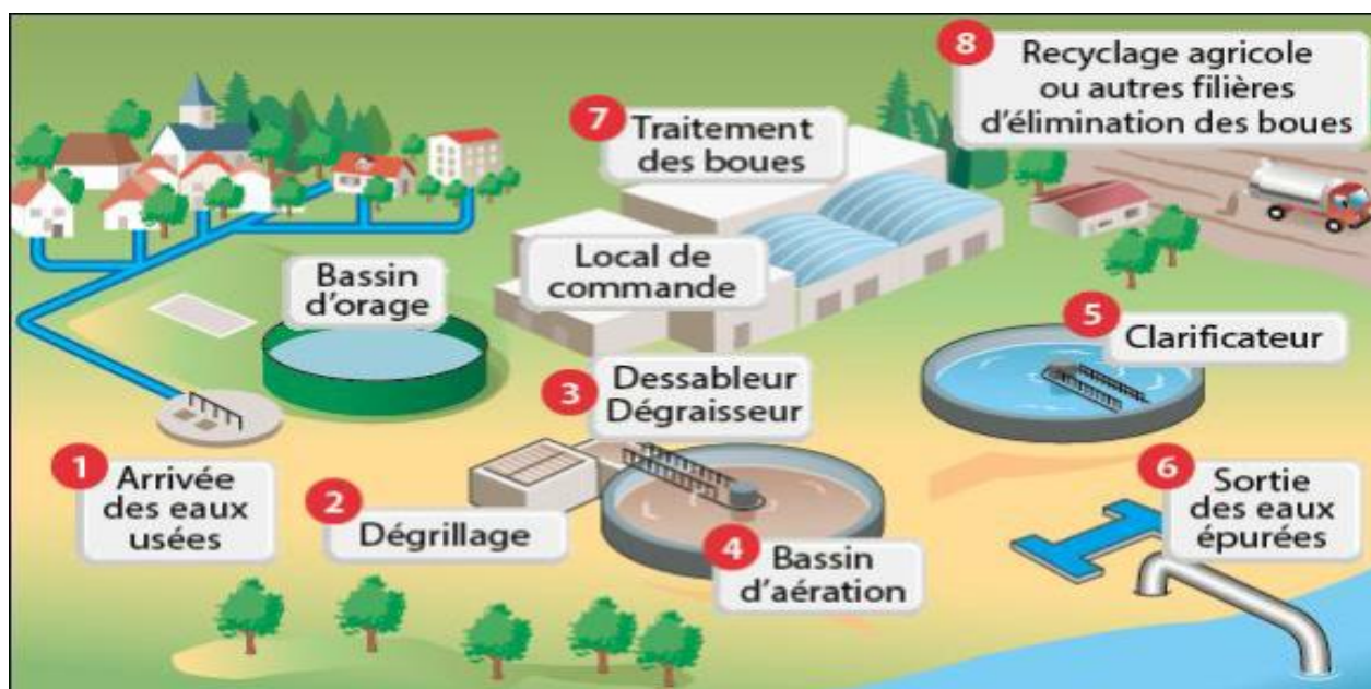
Figure I-4 : Schéma général d'une station d'épuration
