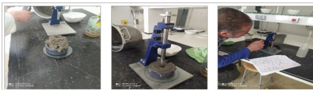
Figure 4.5. Dispositif de mesure du temps de début et de fin de prise
