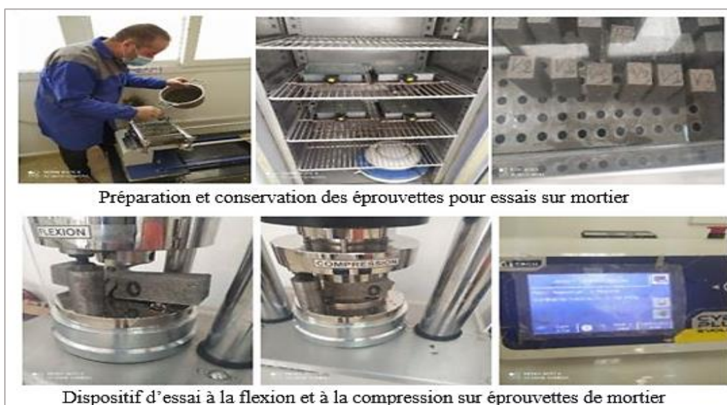
Figure 4.6. Dispositif d'essais sur mortier
