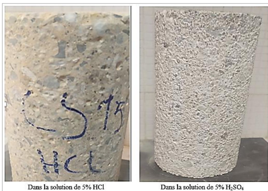
Figure 5.12. Etat des éprouvettes de béton après 12 semaines d'immersion dans les solutions acides (HCl et H 2 SO 4 ).
