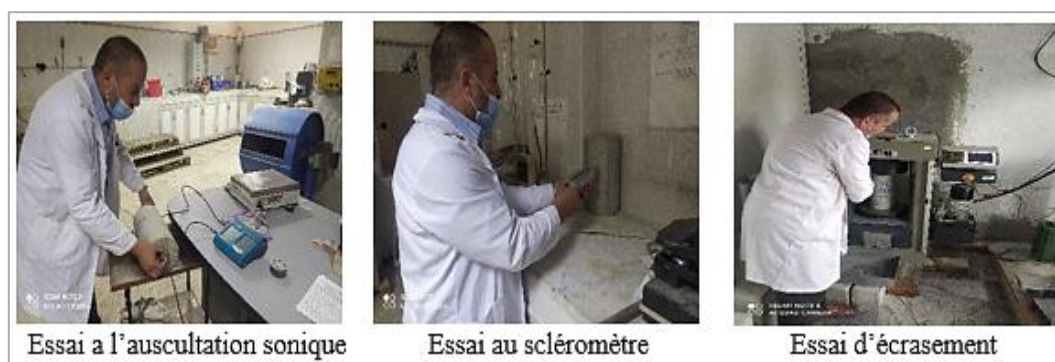
Figure 4.9. Essais réalisés sur béton durci
