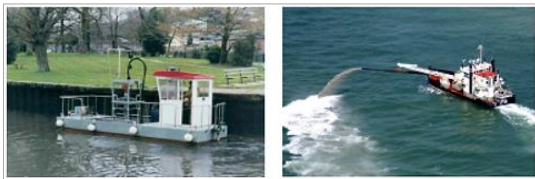
Figure 1.6. La drague à agitation [15]
