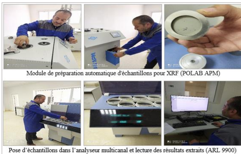
Figure 4.3. Etapes de l'essai XRF sur la boue
