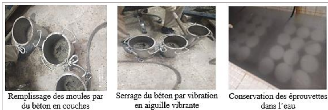
Figure 4.8. Confection et conservation des éprouvettes de béton
