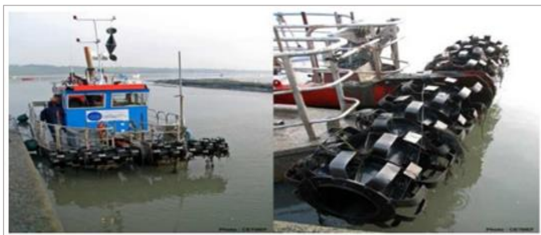
Figure 1.8. Dragage par rotodévaseur [15]
