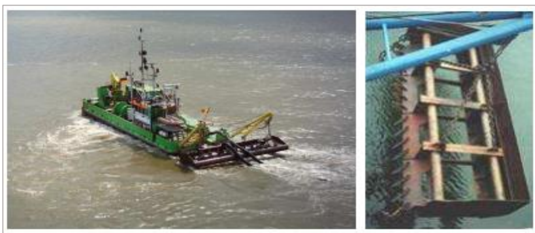
Figure 1.10. La drague à charrue Alligator et détail d'une niveleuse [15]
