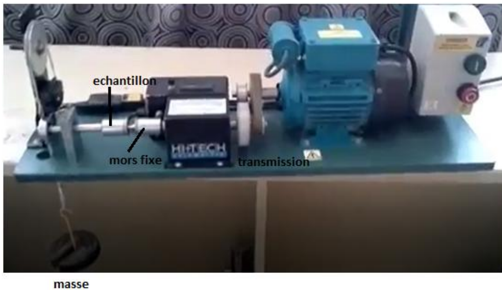
Fig. I.2 : principe de l'essai de Wöhler et [1]
