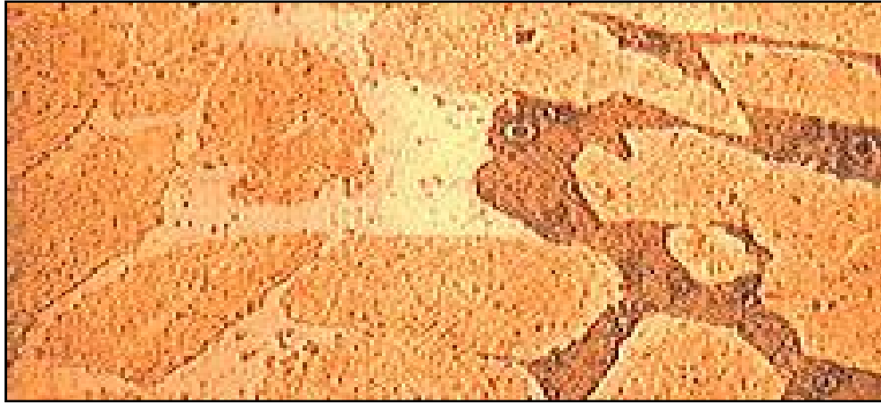
Figure I-10 : Coupe métallographique montrant une corrosion sélective d'un laiton.[5]
