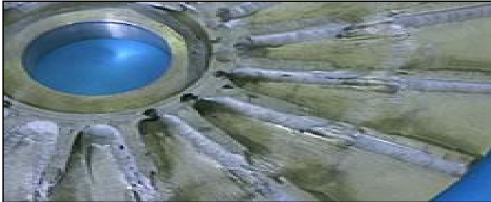
Figure I-4 : Corrosion par cavitation d'une aube de pompe en alliage de nickel Hastelloy C276 en milieu acide chlorhydrique. [5]
