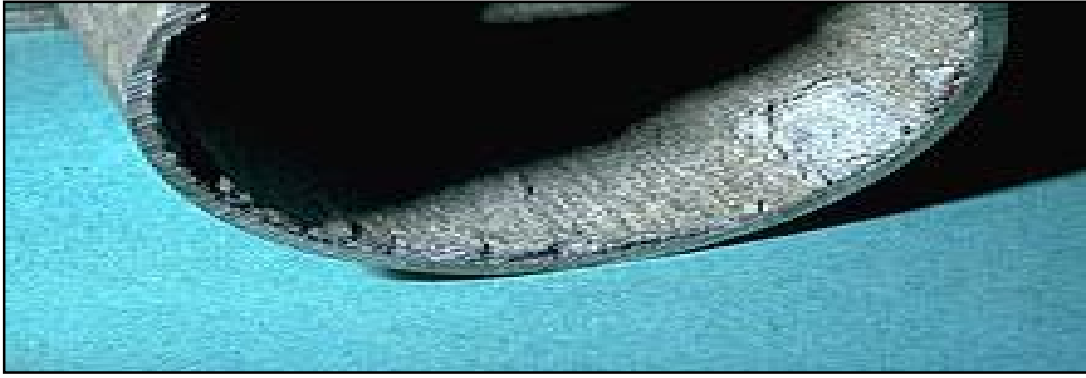
Figure I- 7 : Corrosion feuillettant d'une canalisation en alliage d'aluminium véhiculant de l'eau.
