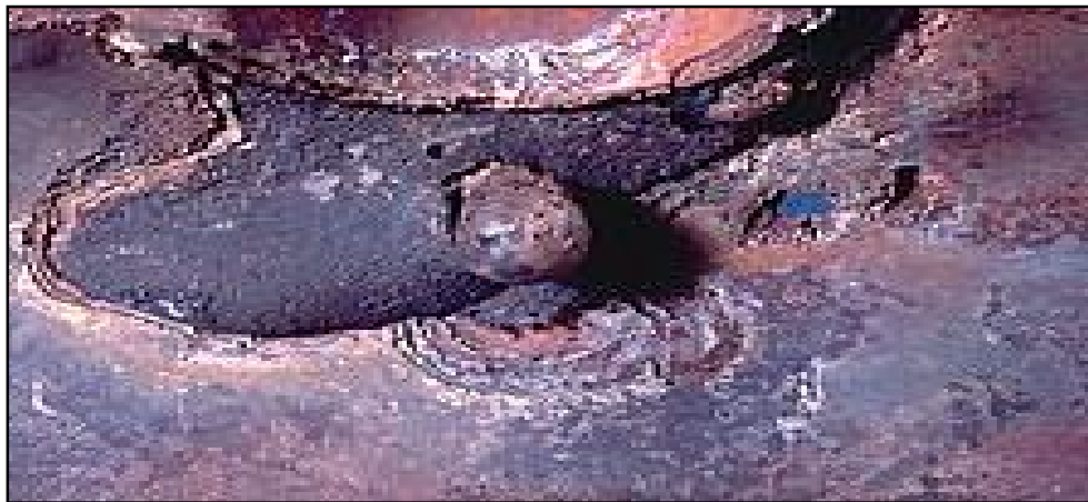
Figure I-9 : Corrosion galvanique au niveau d'une zone de brasage entre la brasure Cu-P et le tube en cuivre. .[5]
