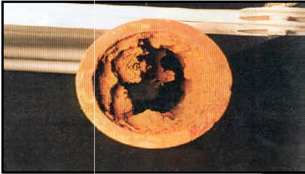
Figure I-2 : conduite affectée par la corrosion à l'intérieur.
