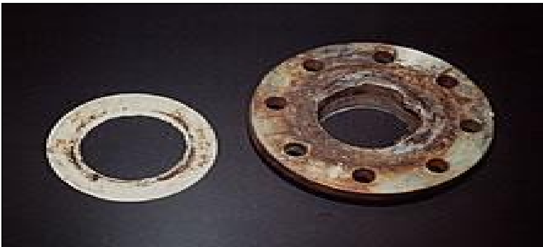
Figure I-8 : Corrosion cavernueuse d'un acier allié sous un joint.
