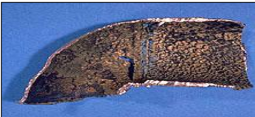
Figure I-3 : Corrosion-érosion d'un tube en cuivre véhiculant de l'eau.[5]
