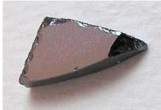
Figure (I-17) : Cristal d'arséniure de gallium.
