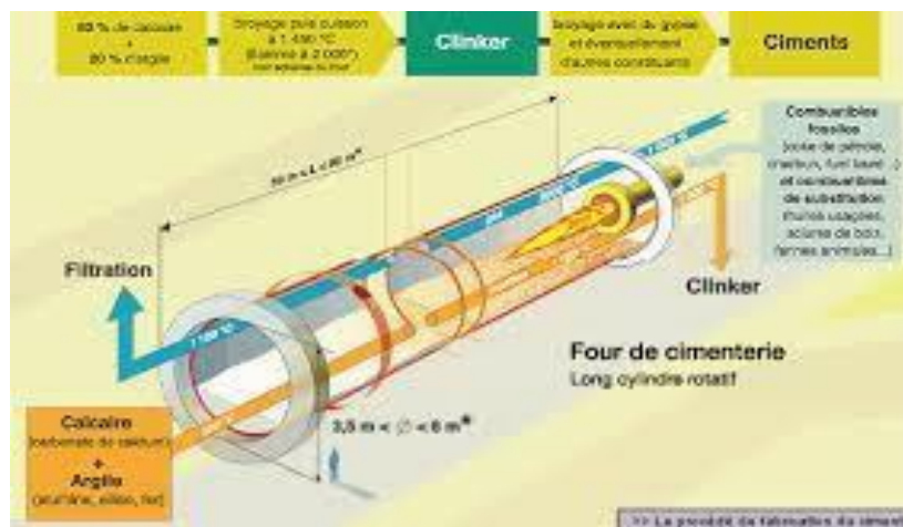
Figure I.21: Schéma indiquant le processus pour l'obtention du clinker
