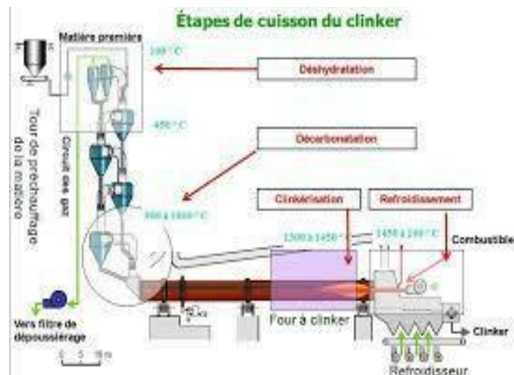
Figure I.24 : Les étapes de cuisson du clinker[7]
