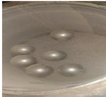
Figure IV.2: Boulets utilisées pour le broyage du clinker
