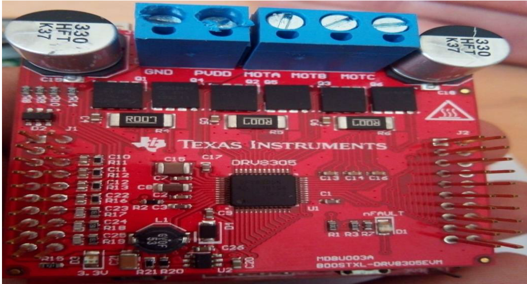
Figure III.7 : Le BOOSTXL-DRV8305EVM- Carte d'évaluation, DRV8305N BoosterPack Driver moteur triphasé, 15A, Tension d'entrée 4.4V à 45V
