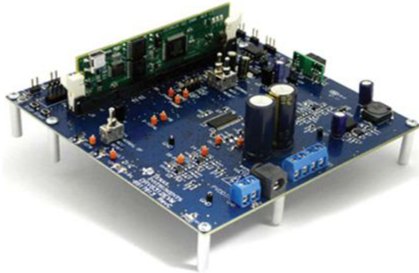
Figure II.10 : Le kit d'évaluation des moteurs BLDC triphasés de TI est basé sur le variateur moteur PWM DRV8312. [21]
