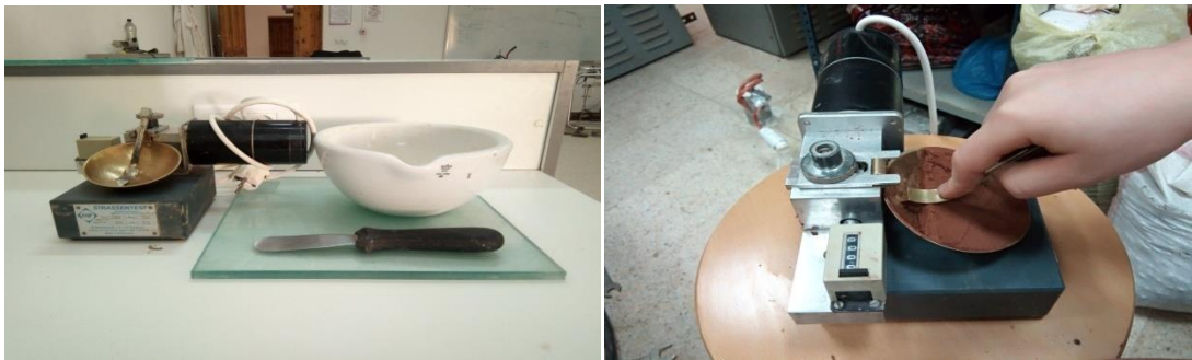
Figure IV.5 : Appareillage de limites d'Atterberg.
