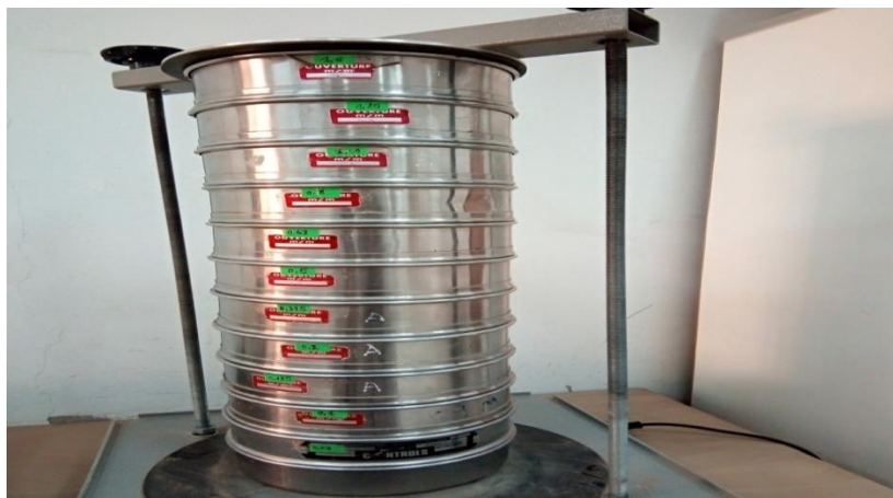
Figure IV.3. Dispositif expérimental de l'essai d'analyse granulométrique.
