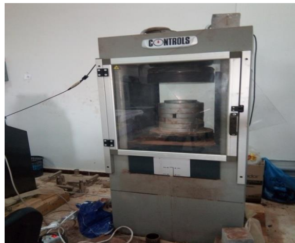
Figure IV.13: Presse hydraulique pour l'essai de compression (avec une pression de 3000KN).
