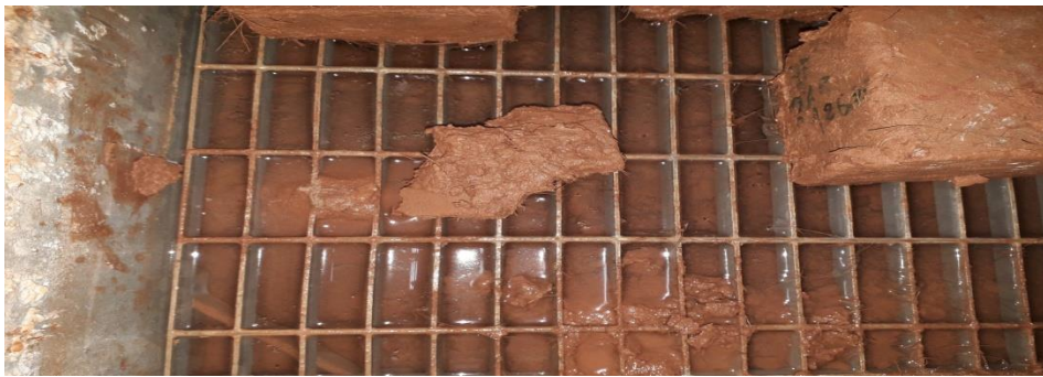
Figure V.10. dissolution du BTC non stabilisé
