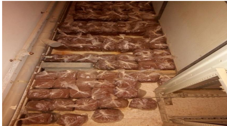
Figure IV.12: La cure des éprouvettes.
