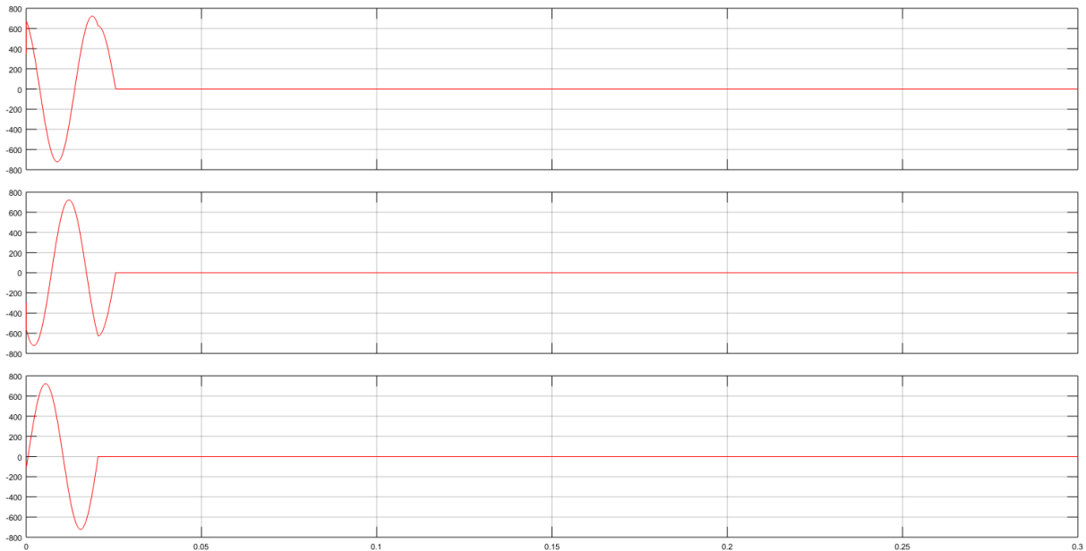
Figure V-8 : Courant secondaire après le défaut (A)
