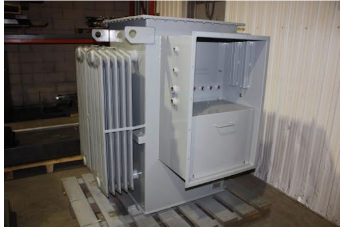
Figure II-15 : La cuve de transformateur
