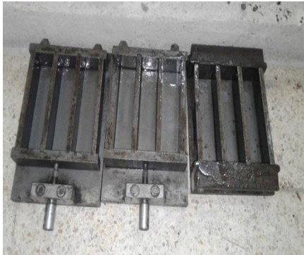
Figure (IV-8) : Moule d'éprouvettes Prismatiques (4x4x16) cm.
