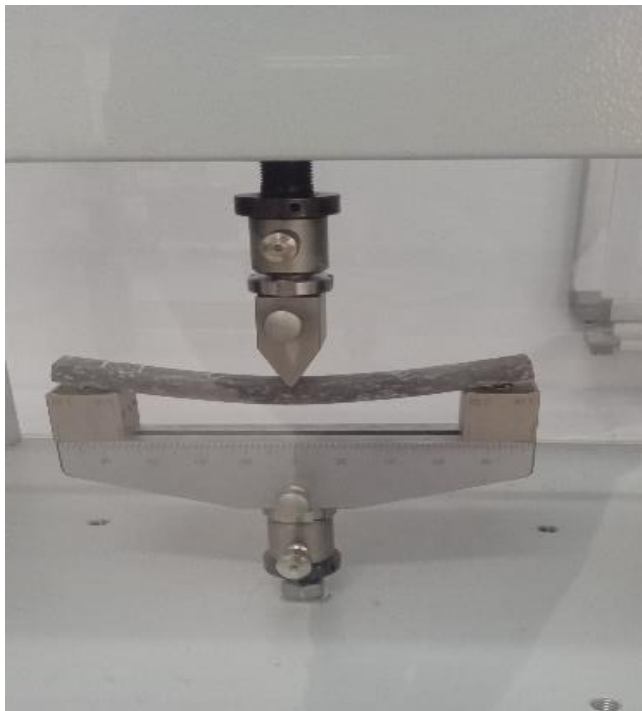
Figure II-20 Essais de flexion sur la machine TEST
