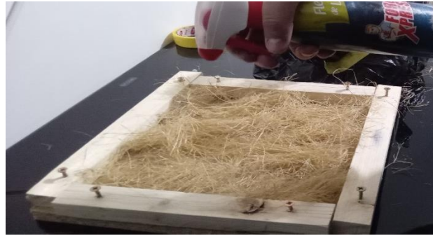
Figure II-12 Fixation des fibres du pli par pulvérisation de résine à l'aide d'un pistolet.
