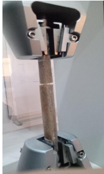
Figure II-19 Essais de traction sur la machine TEST
