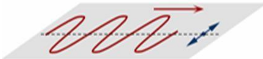
Fig.28: Ondes sismiques de LOVE (Source: Bourque, 2004)
