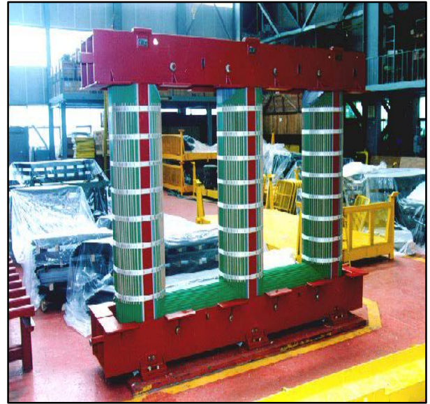
Figure (I-28) : Le circuit magnétique d'un transformateur triphasé
