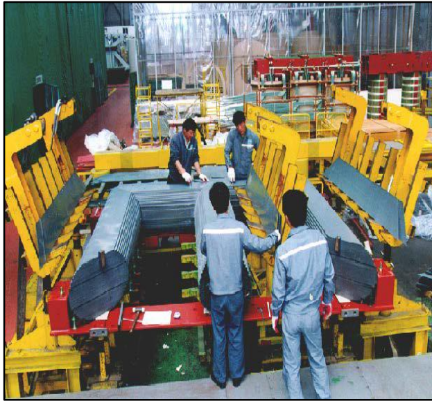
Figure (I-28) : Le circuit magnétique d'un transformateur triphasé
