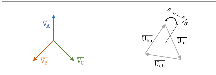
Figure (II-20) : Le diagramme vectoriel du système inverse d'un transformateur(Yd1)
