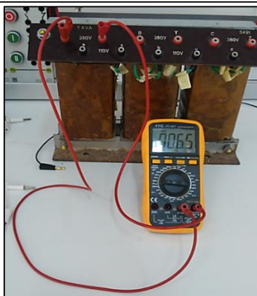
La résistance : r_1 = 6.5 \Omega
