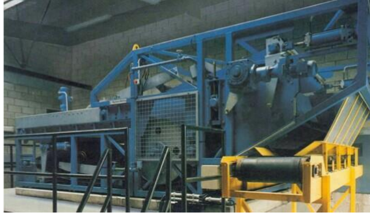
Figure I. 5 .le procédé filtre bande.
