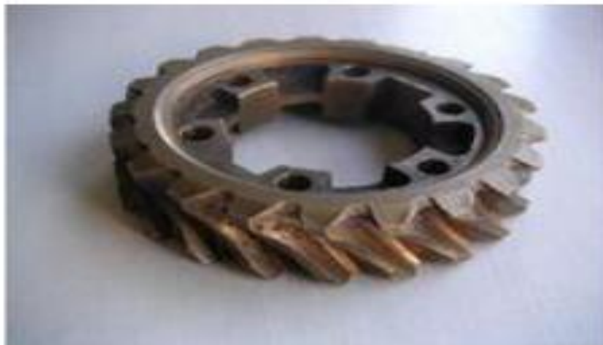
Figure 1-25 : Dégradation des dents d'une roue dentée [9].
