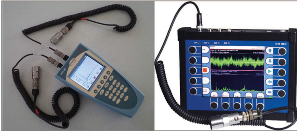
Figure.N° III-22 : collecteur analyseur de vibration (Documentation Bruel et Kjaer)
