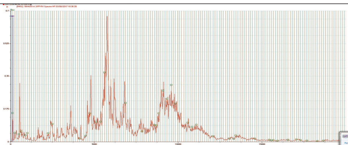
Figure N° V-33 : Spectre haut fréquence zoomée autour de la fréquence F_{be} du roulement
