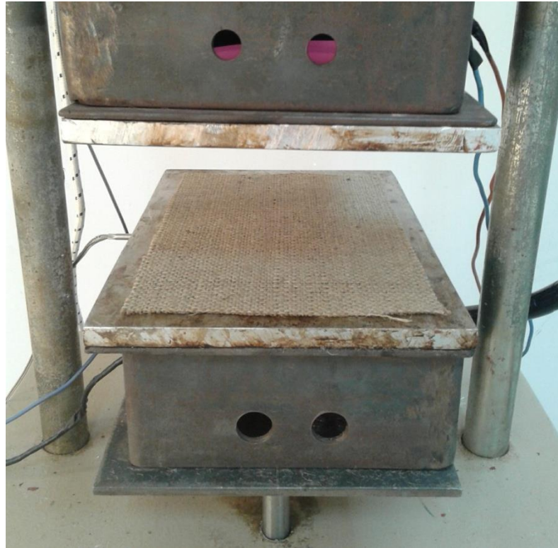
Fig. IV.10. Représenté la compression des tissus de Jute
