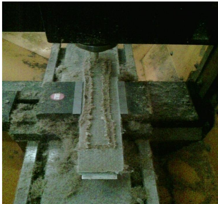
Fig. IV.12. usinage d'éprouvette par CNC
