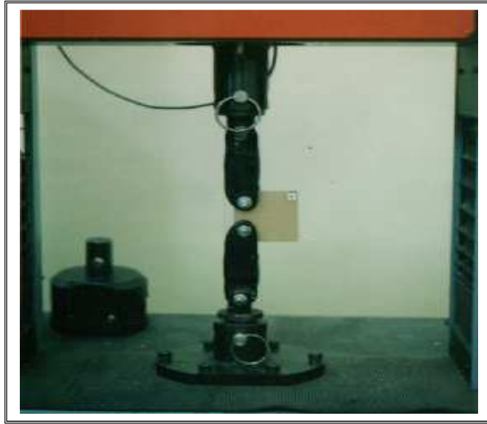
FIG. IV. 3: Montage de fixation de l'éprouvette «CT»
