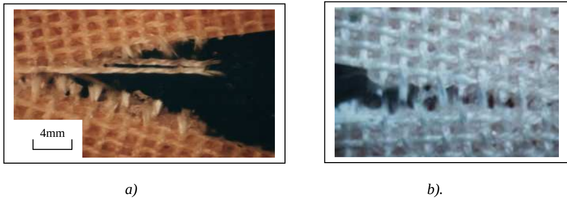
FIG.VI.31: faciès de rupture, pris dans le sens latéral du ligament rompu de «CI»
