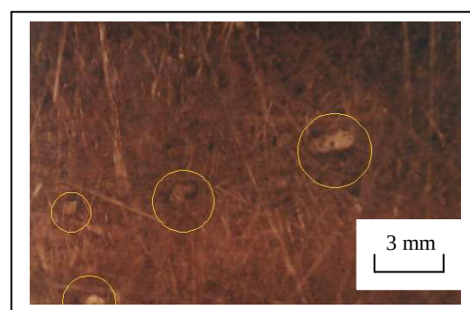
FIG. VI. 9: Photographie représentative d'une anisotropie initiale «présence des pores».
